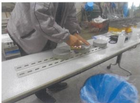
写真2 試験体作製状況 [レイタンスの除去作業]
