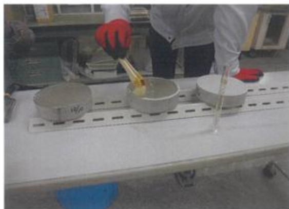
写真3 試験体作製状況 [防水材の塗布作業]
